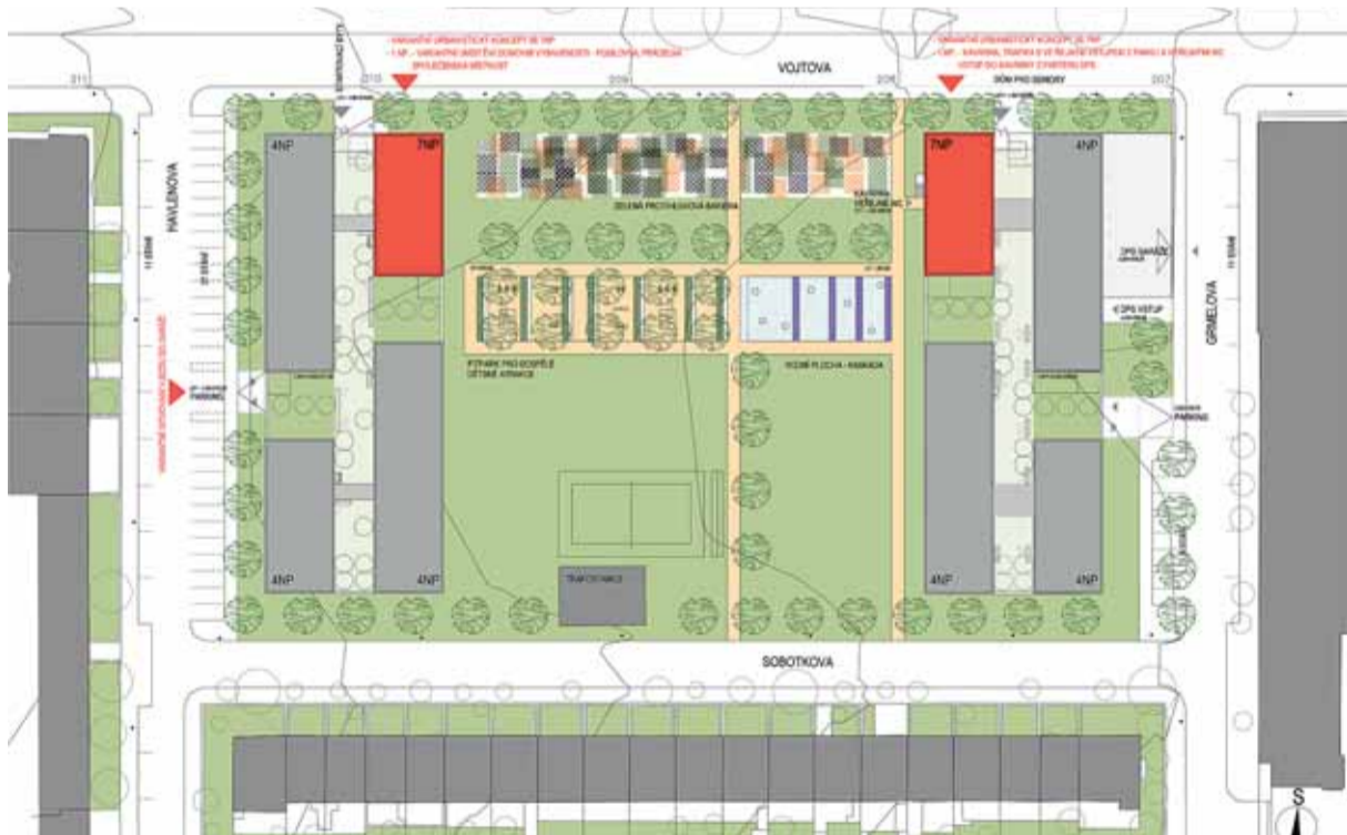
■ Situační plán ukazuje rozmístění čtyř bloků a veřejného parku mezi nimi. Zdroj: architektonická studie ateliéru Rudiš-Rudiš architekti
