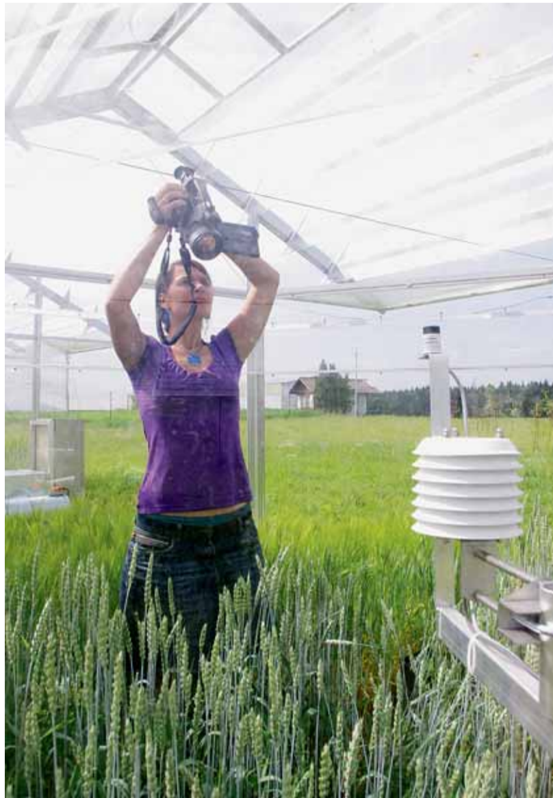
Ve sklenicích lze sledovat vliv oxidu uhličitého či ozonu, teploty, sucha, UV záření a obsahu dusíku na rostliny. Foto: CzechGlobe
