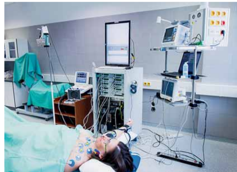
Mapování vlastností cév pomocí celotělové impedanční pletysmografie. Foto: ICRC
