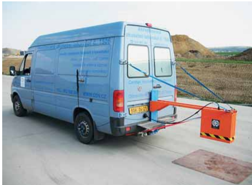
Georadar slouží pro monitorování poruch pozemních komunikací a mostních konstrukcí. Foto: CDV
