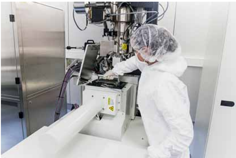
Elektronový litograf umožňuje rychlou expozici obrazových předloh ve velkém rozlišení do tenké vrstvy nanosené na podložce. Foto: ALISI
