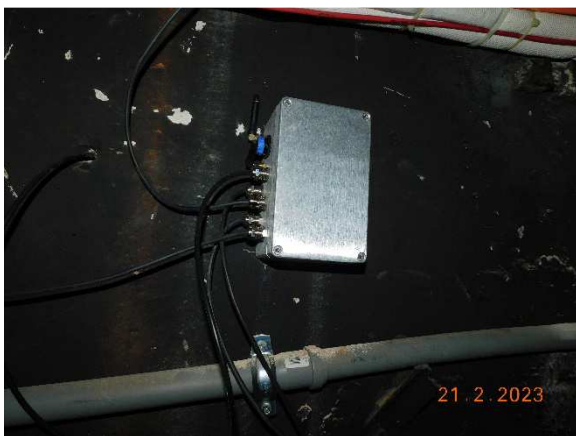
Foto z instalace 21.2.2023. 2x snímače DH15 + 2x náklonoměr IOTIN.
