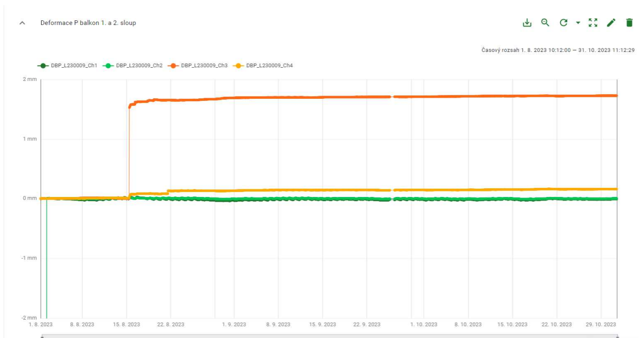
Obr.72: Záznam ze snímačů osazených na nejvíc poškozeném sloupu
