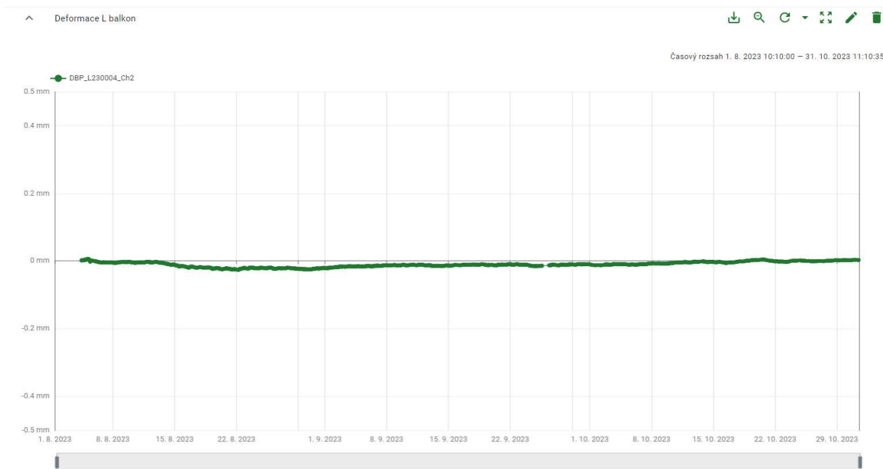
Obr.73: Záznam ze snímače osazeného na straně do Jakubského náměstí
