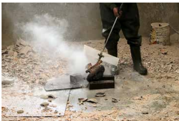
Po vychladnutí kovu se keramická forma mechanicky rozbije.
