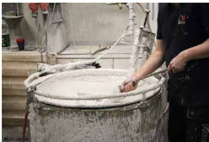
Voskový model se namáčí do keramické suspenze a obaluje pískem, poté se vypálí v peci.
