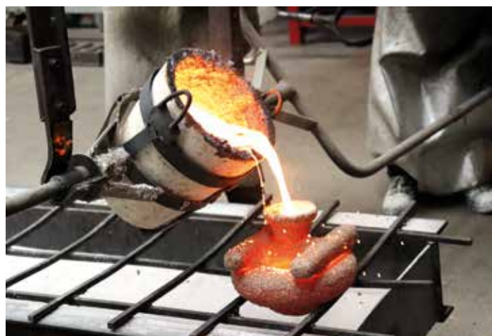
Do vypálené keramické formy se lije roztavený bronz.
